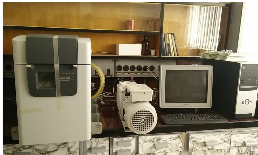
Քրոմատո-մասս-սպեկտրոմետրային կոմպլեքս՝ անհայտ բնույթի միացությունների որոշման համար
